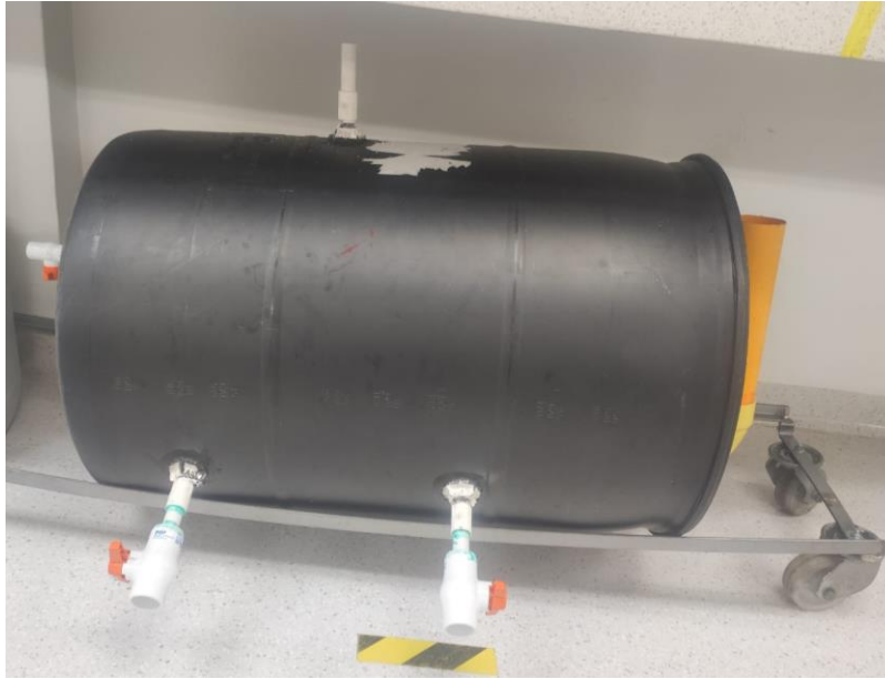
Ilustración 9 Biodigestor con todas las conexiones
