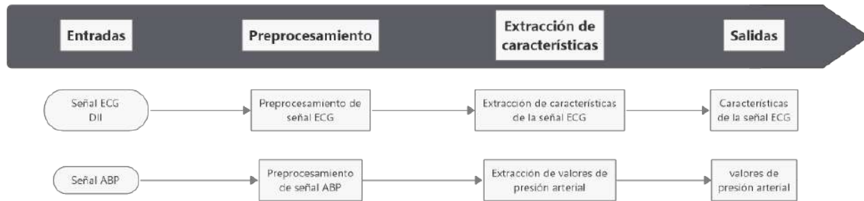
Fig. 3.2. Proceso general de extracción de características de la señal ECG y ABP.
