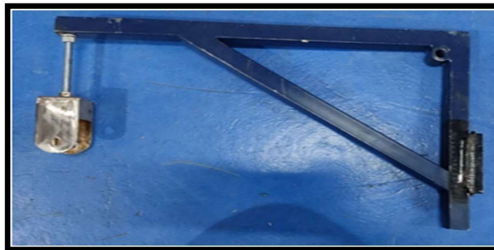
Figura 45 Construcción de brazo y porta probeta
