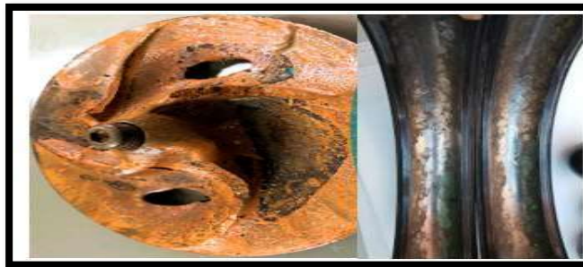
Figura 5 Desgaste por corrosión [4]
