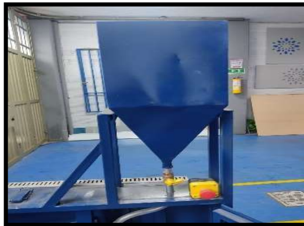
Figura 43 Tolva fabricada y con válvula de paso
