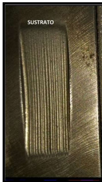
Figura 71 Huellas de desgaste abrasivo del sustrato de fundición gris [6]
