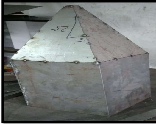
Figura 42 Fabricación de tolva
