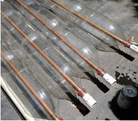
Fotografía 32: Botellas con tubos de cobre. Fuente: Armenta et al., 2018.
