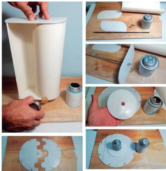
Fotografía 23: Corte y pegada del tubo PVC. Fuente: Solarpedia, 2023
