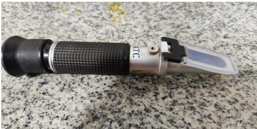
**Imagen N° 2:** Refractómetro de azúcar en grados BRIX
