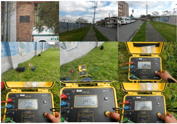
Figura 3. Telurómetro AEMC – Equipo medidor de resistividad del terreno Fuente: PROYECTO CAE EL REDENTOR Diagonal 58Sur No. 28-19 – Tv. 30 No. 57-50sur.
