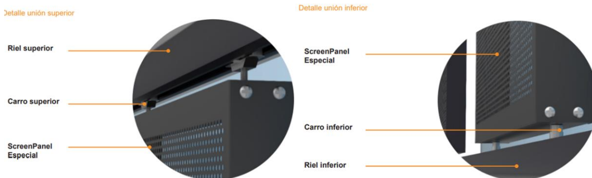
Figura 7.39 Detalle de unión de paneles screen.
