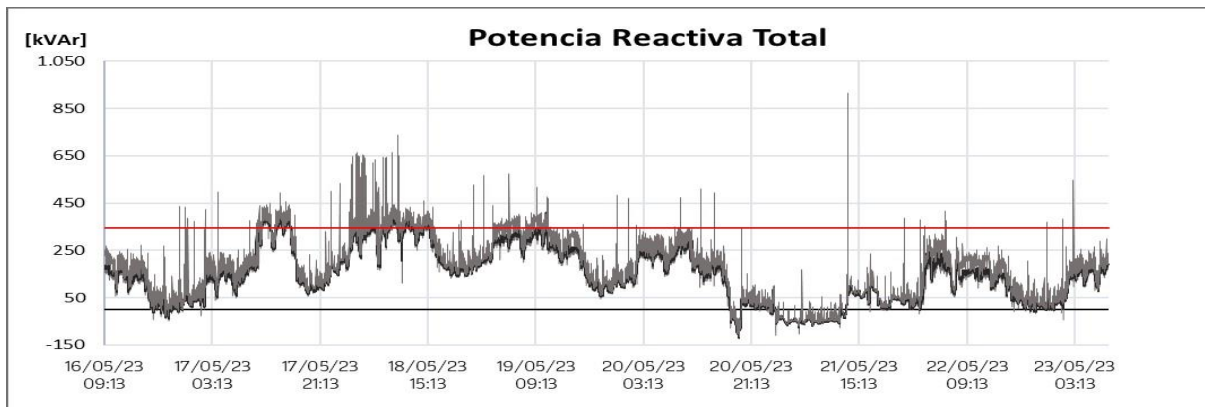
Figura 25 - Perfil de potencia reactiva escenarios de operación
