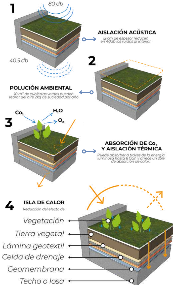
Figura 120: Funcionamiento de cubierta verde
