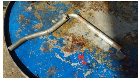
Fig. 16. Tubo para presión de gas 0.08 metros de largo, 1.7 cm diámetro exterior y 1.2 cm diámetro interior
