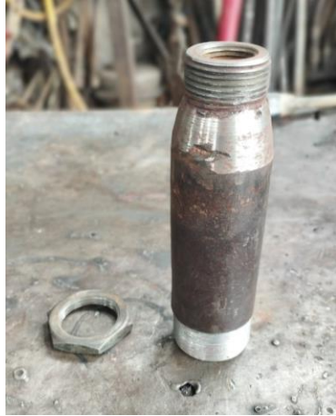
Fig. 7. Con ayuda de un torno se centra y se procede a soldar el buche que habíamos preparado anteriormente, teniendo en cuenta que la altura final debe ser muy aproximada al cilindro original del gato.
