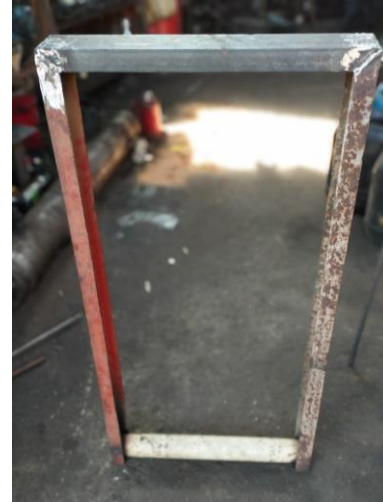
Fig. 10. Las vigas se cortan procurando darle las medidas especificadas en la figura 8. A la viga más corta se le hace un corte de 45° en sus dos puntas y a las más largas solo en una respectivamente para después ser soldadas por arco eléctrico (MMA). Por ultimo procedemos a soldar el tubo en la parte inferior procurando que este quede no sobresaliendo por la punta de los ángulos. A la viga superior es necesario hacerle un orificio de 5/8 por donde pasara un tubo con el aceite.
