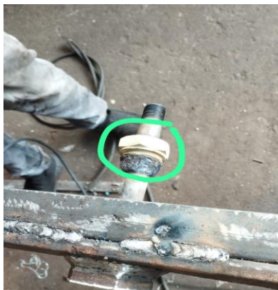
Fig. 21. Válvula de retención 5/8 para sistema de aire. Se usa soldadura por arco eléctrico para soldar el tubo de presión a la válvula de retención y así aprovechar la rosca que pasee.
