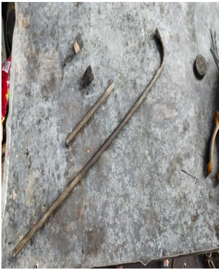
Fig. 25. Tubo acerado de 10 mm y 77 cm de largo Tamaño final Porque se manda a soldar en dos secciones con soldadura autógena para darle la forma final que se utilizara en la prensa.
