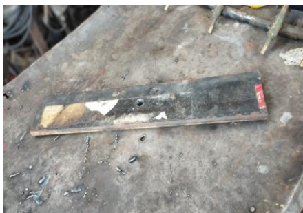
Fig. 13. Platina de 0.43 metros de largo, 3 in ancho y 1/2 in espesor.
