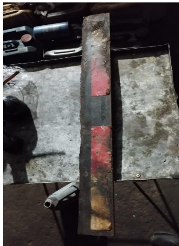
Fig. 13. Platina de 0.43 metros de largo, 3 in ancho y 1/2 in espesor.
