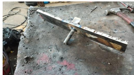
Fig. 17. Se suelda la tuerca a la platina de refuerzo utilizando el método de arco eléctrico (MMA)
