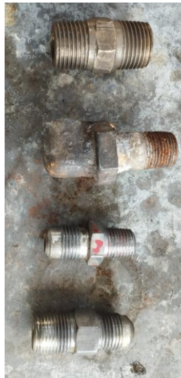
Fig. 22. Racor, unión para presión de aire 3/4, Codo galvanizado de 5/8, 2 uniones 5/8 para presión hidráulica
