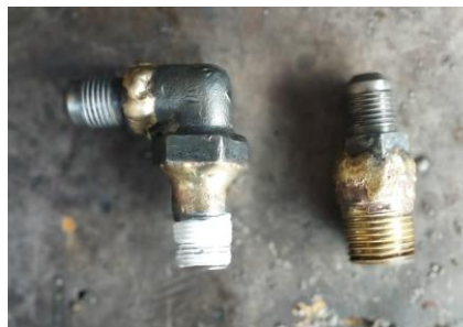
Fig. 23. Se cortan la uniones para presión hidráulica aprovechando el lado que hace sello con las copas y se procede a soldar una union al codo y la otra al racor previamente cortado y aprovechando la rosca que encaja con el buche de la fig. 3. Se utiliza soldadura autogena con varillas de bronce.
