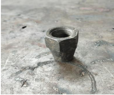
Fig. 24. 2 copas para presión hidráulica para tubo de 10 mm
