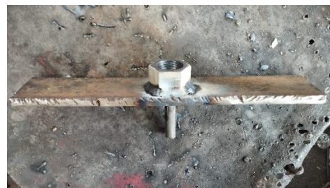
Fig. 17. Se suelda la tuerca a la platina de refuerzo utilizando el método de arco eléctrico (MMA)
