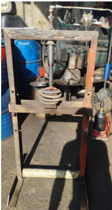
Fig. 30. Resorte de prueba con la prensa realizando trabajo de presión
