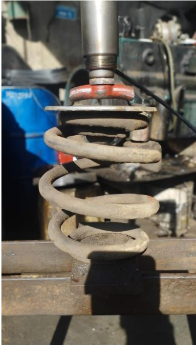
Fig. 29. 1 1/2 cm de espesor Resorte de seguridad de cámara de freno
