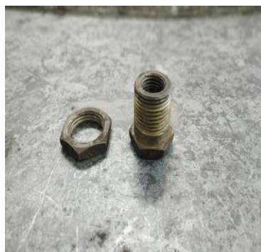
Fig. 3. Buche con tuerca 3/4 in diámetro interior, 1 3/16 in diámetro exterior.
