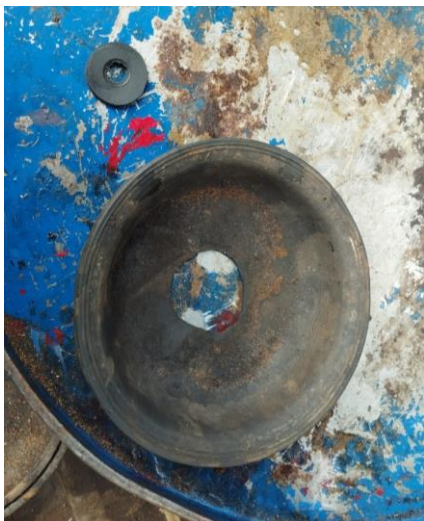
Fig. 19. Empaque hecho de diafragma 24 de cámara de freno, 1 1/2 in diámetro exterior y 1/2 in diámetro interior.
