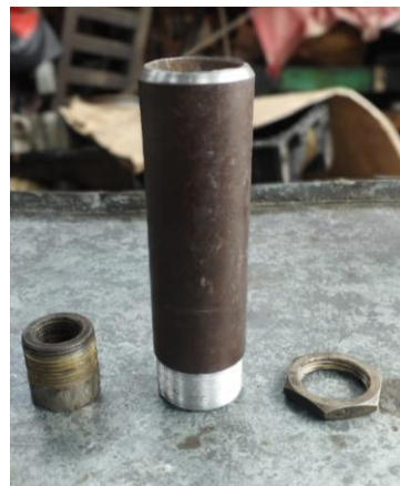
Fig. 6. Al tubo de transversal se le corta un pedazo el cual es aproximado al tamaño del cilindro encargado de contener los pistones ya que tanto el cilindro como los pistones serán reemplazados por el tubo. Mediante torno se procede a darle forma a la rosca del tubo de transversal para que este se pueda montar sobre la base del gato.
