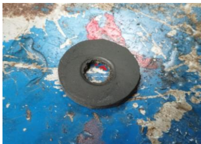
Fig. 20. Este empaque debe ir ubicado dentro de la tuerca mencionada en la fig. 15, realizando la labor de sellar posibles fugas que se puedan presentar entre la tuerca y el pistón.
