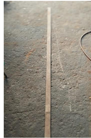
Fig. 11. 1 platina de 1 1/2 metros de largo, 2 in de ancho y calibre 5/16 in.
