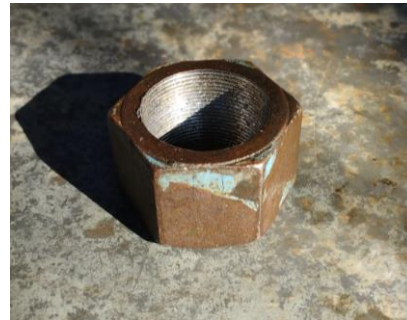
Fig. 15. Tuerca de 1 3/8 in y 4 cm altura, se envía al torno para reformar la rosca para 1 1/2 in de diámetro dentro de la rosca después de reformada la rosca. Y se procede a cortar la tuerca para darle una altura de 2 cm lo cual es un poco menor a la rosca del cilindro del gato el cual deberá ir montado en la tuerca.
