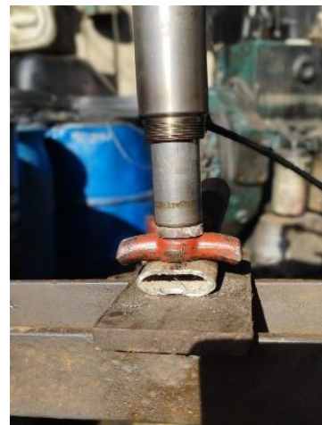
Fig. 28. Tubo de prueba con la prensa realizando trabajo de presión
