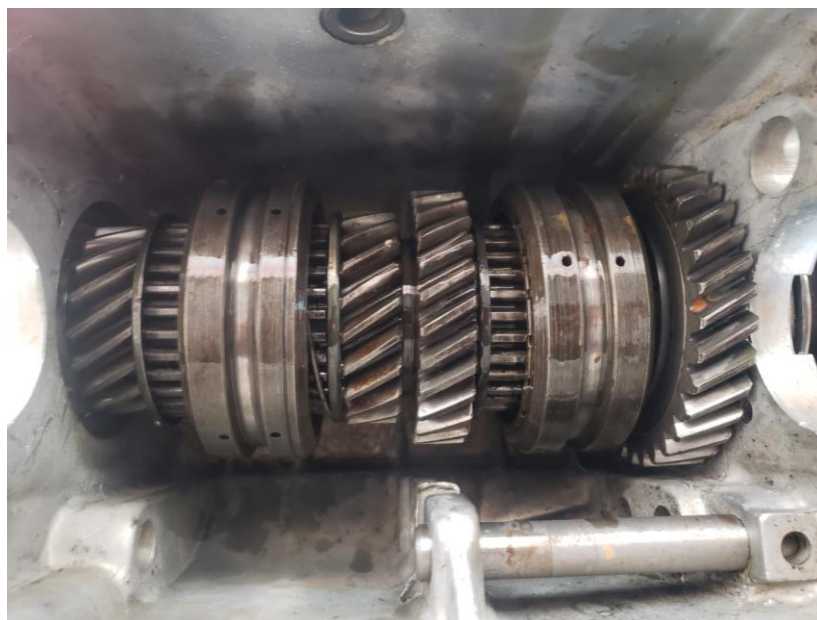
Figura 16. Vista superior de la caja de cambios
