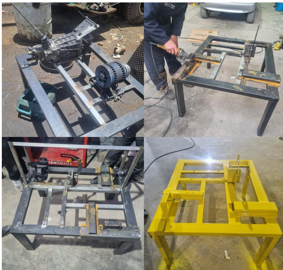
Figura 19. Estructura Banco Didáctico
