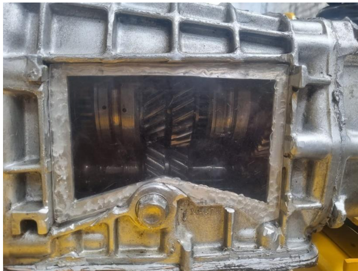
Figura 15. Instalación Ventana acrílica en la carcasa de la caja de cambios
