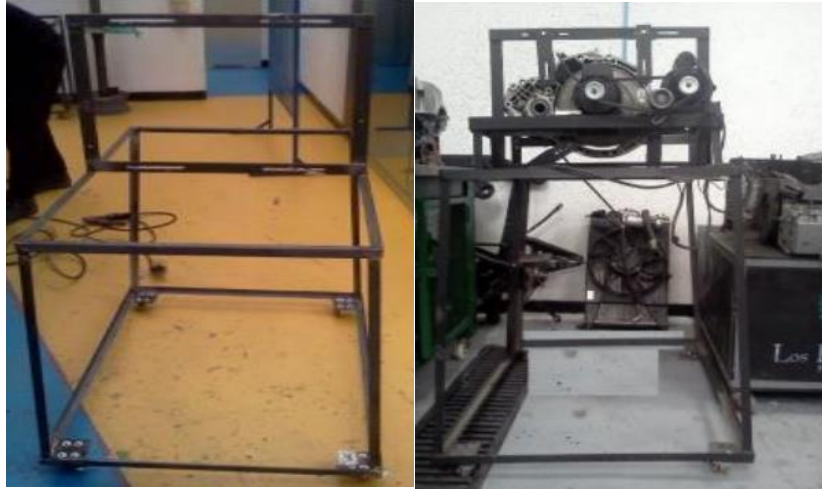
Figura 2. Estructura del Banco
