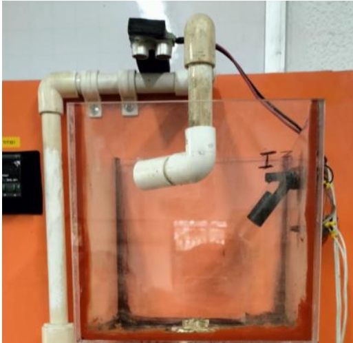
Fig. 20. Switch horizontal de nivel restaurado
