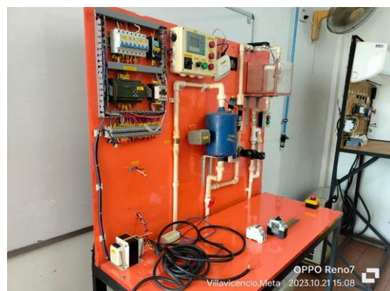
Fig. 4. Banco didáctico de variables industriales de proceso
