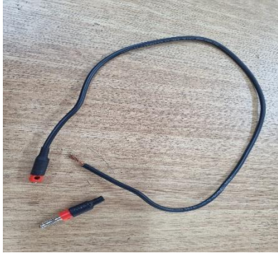
Fig.8. conductor eléctrico del banco de control didáctico electromecánico de contactores para arranques de motores eléctricos trifásicos.
