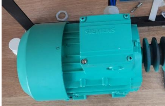
Fig25 motor del banco de control didáctico electromecánico de contactores para arranques de motores eléctricos trifásicos.
