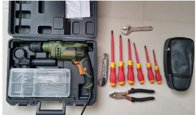
Fig.15.herramienta utilizada en el desmantelamiento del tablero eléctrico del banco de control didáctico electromecánico de contactores para arranques de motores eléctricos trifásicos.
