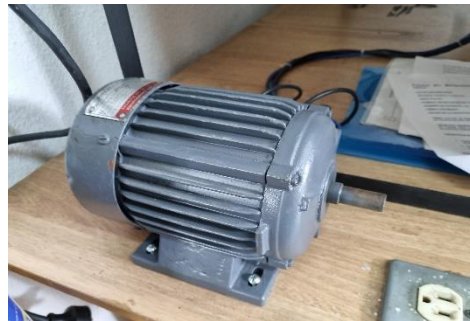
Fig.6. motor trifásico del banco de control didáctico electromecánico de contactores para arranques de motores eléctricos trifásicos.
