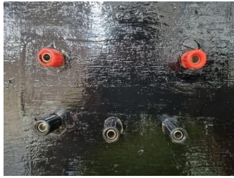
Fig.19 restauración puertos de conexión del banco de control didáctico electromecánico de contactores para arranques de motores eléctricos trifásicos.
