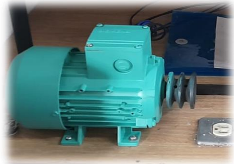
Fig26 motor del banco de control didáctico electromecánico de contactores para arranques de motores eléctricos trifásicos.
