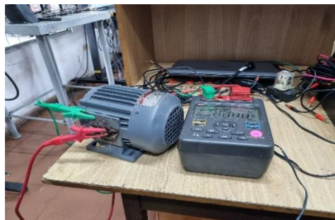
Fig.7. motor trifásico del banco de control didáctico electromecánico de contactores para arranques de motores eléctricos trifásicos pruebas de aislamiento
