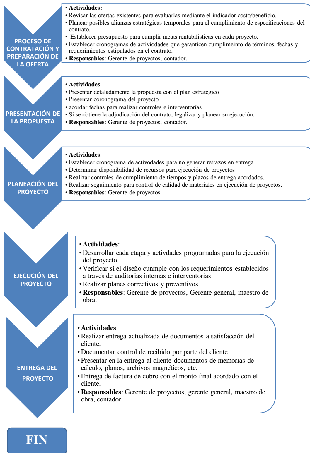
Figura 9. Flujograma Etapas para generar un proyecto de construcción
