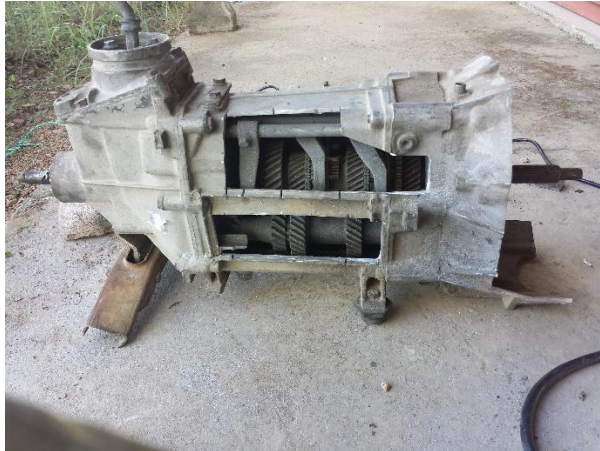
Figura 25: Corte de la carcasa de la caja de cambios. Fuente: Autor
