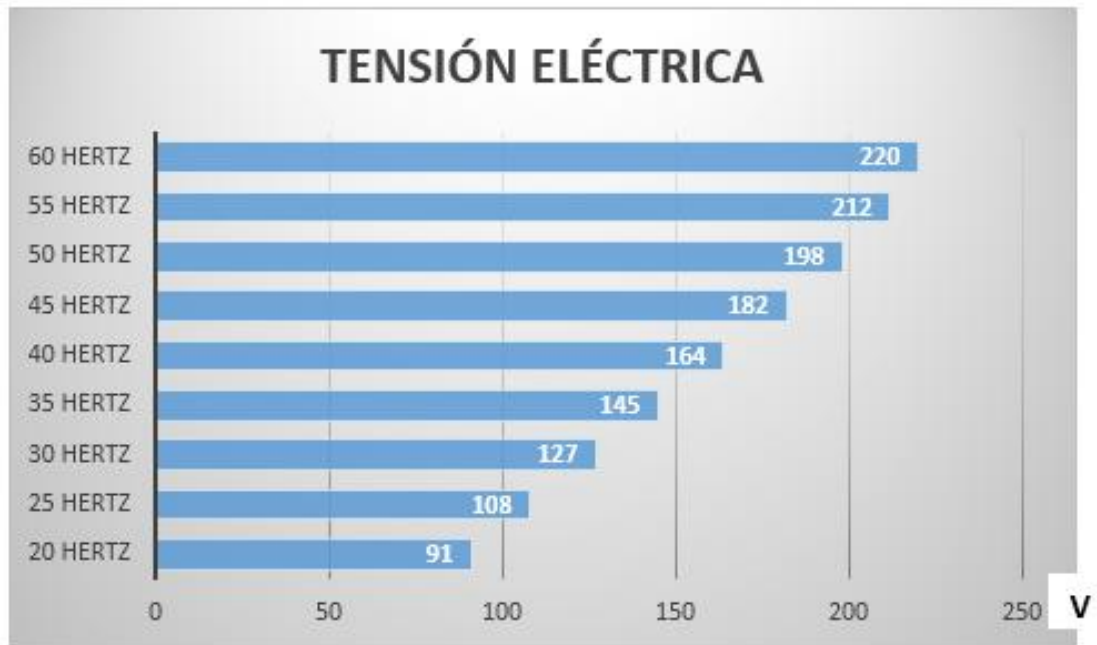
Figura 46: Grafico del comportamiento de la tensión eléctrica en el sistema cuando funciona a diferentes frecuencias y velocidades de la caja de cambios.
