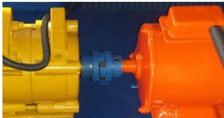
Figura 29: Acople tipo araña acoplado.
