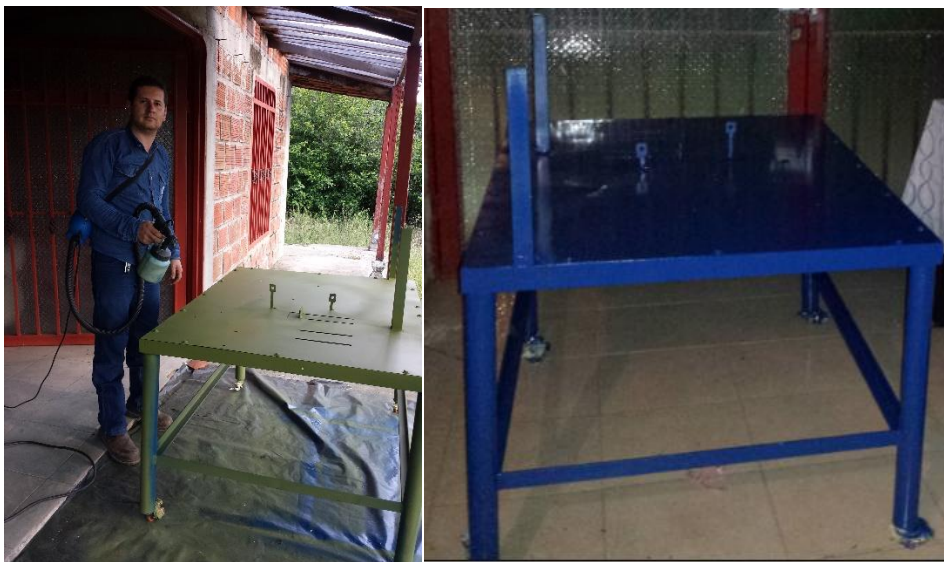
Figura 21: Labores de pintura del soporte.
