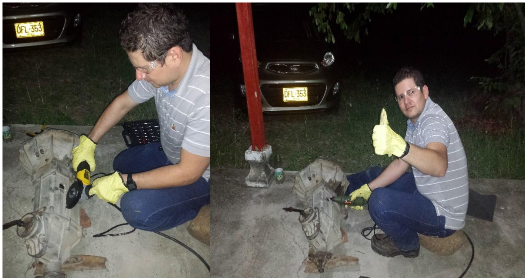
Figura 24: Corte de la carcasa de la caja de cambios.
