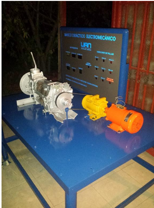
Figura 33: Tablero de instrumentos y de indicadores de fallas acoplado. Fuente: Autor
