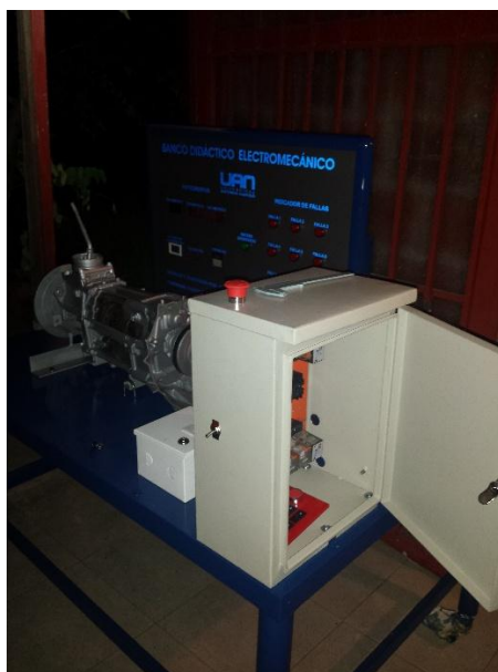
Figura 34: Caja eléctrica y de botones instaladas. Fuente: Autor
