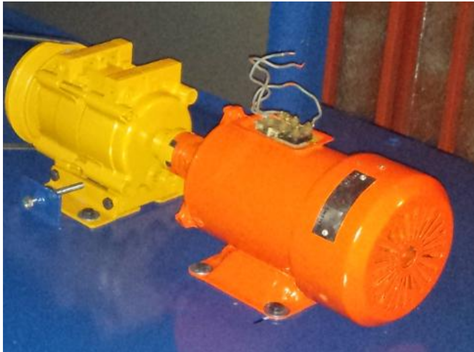
Figura 31: Motor de inducción acoplado al embrague electromagnético con acople tipo araña.
