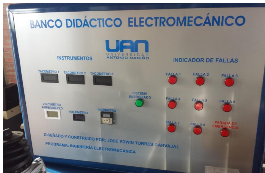
Figura 22: Tablero de instrumentos y de indicadores de fallas ensamblado totalmente.
