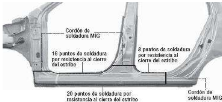
Figura 48. Ensamble parcial del bastidor en carrocería con soldadura MIG/MAG según el manual del fabricante («Base de datos fascículos Cesvi Colombia», s. f.)
