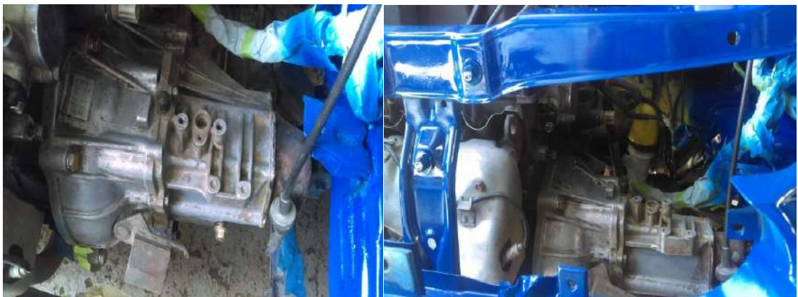
Figura 54. Sistema de transmisión en montado en el banco de prueba
