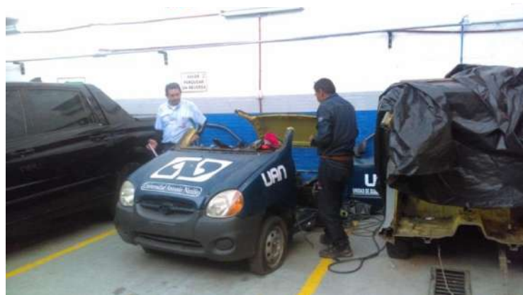
Figura 42. Cortes de la correería parte delantera
