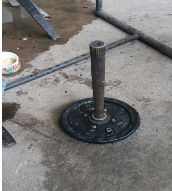
Figura 14. Instalación brazo axial de freno de tambor y disco.
