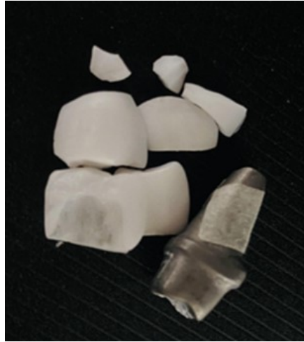
Figura 9 Corona cementada con cemento THERACEM®. Se observa fractura vertical incompleta y restos del agente cementante en la superficie interna de corona y muñón.
