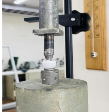
Figura 6: Corona sometida a pruebas de compresión en prensa servohidráulica.
