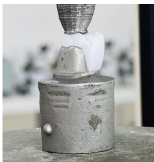
Figura 8 Corona cementada con cemento BISCEM®: Se observa fractura completa de la corona sin presencia de restos del agente cementante.
