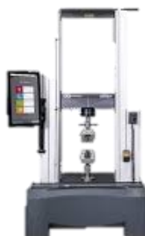
Figura 7: Prensa servo hidráulica universal utilizada en la fractura de las coronas en zirconia.
