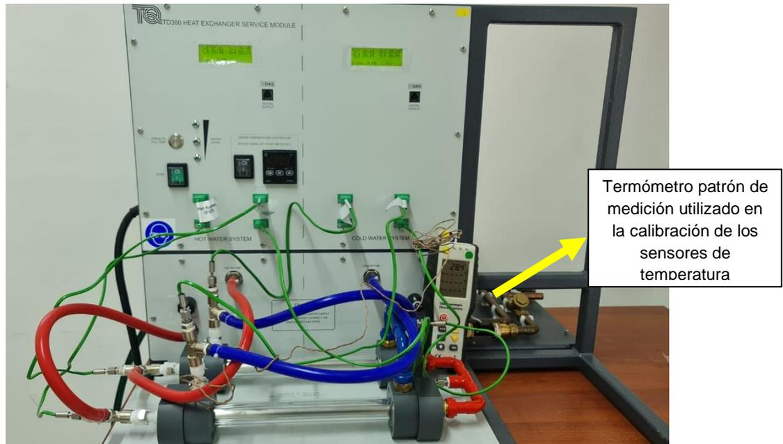
Figura 2. Calibración *in-situ* de los sensores de temperatura del intercambiador de calor
