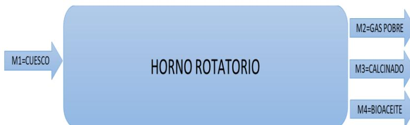
**Figura 7.** Diagrama de carbonización
