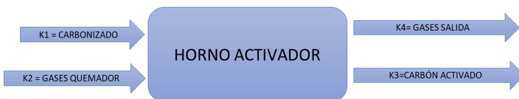
Figura 11. Diagrama balance horno activador
