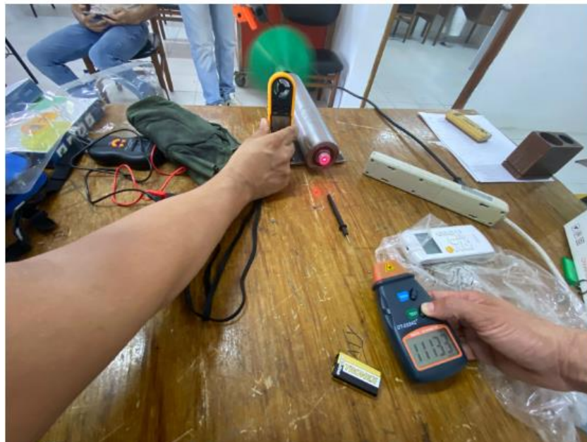
Figura 22. Prueba inicial con el tacómetro y anemómetro
