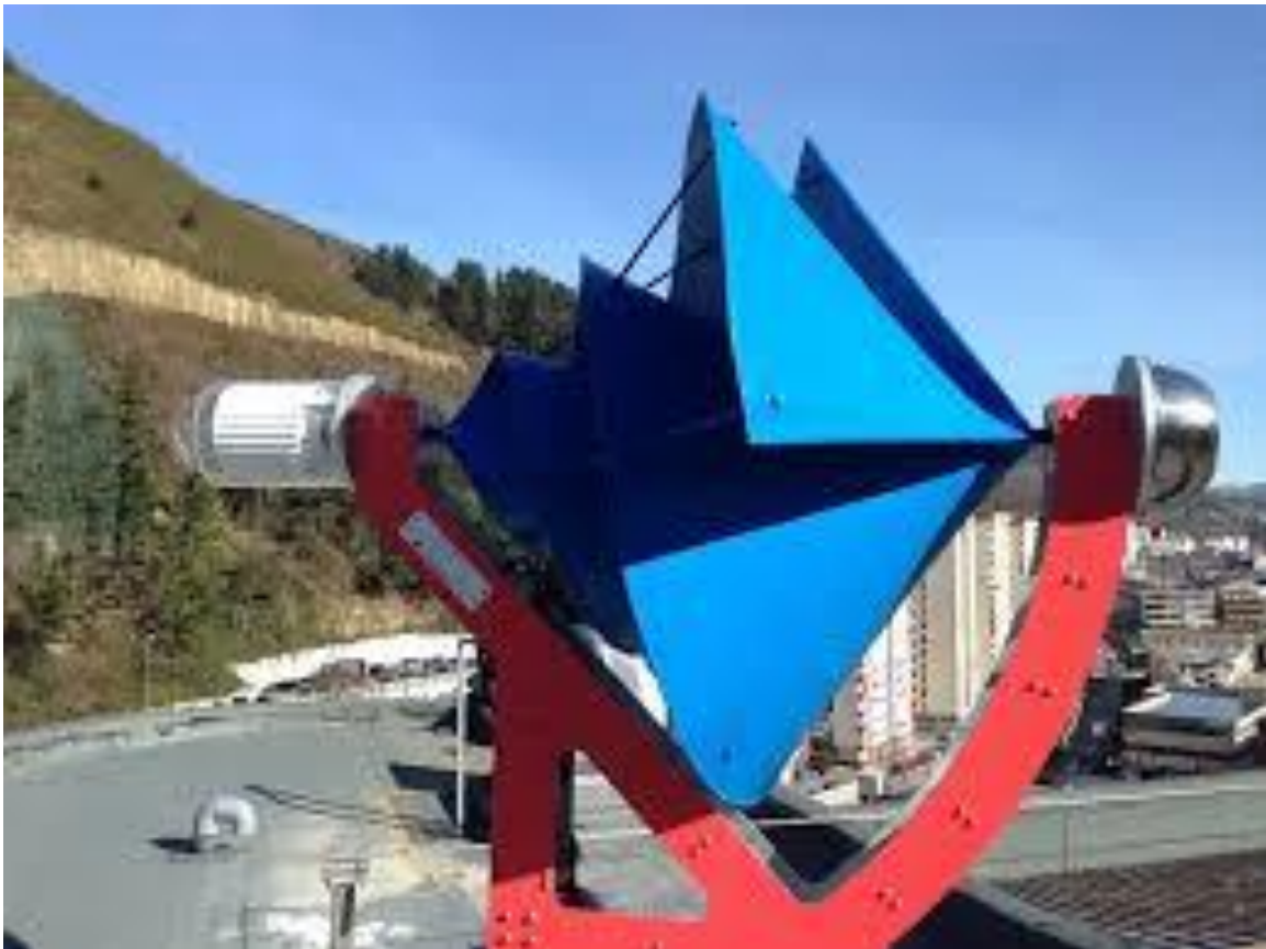
Figura 3. Diseño del rotor en forma de espiral de Arquímedes
