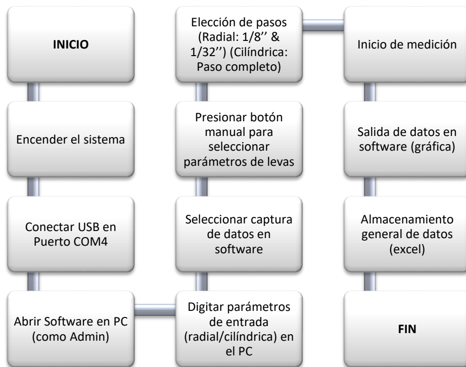
Figura 5.1 Diagrama de bloques – Funcionamiento del sistema.
