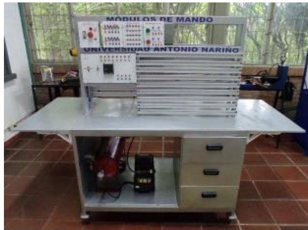
Figura 2.5 Banco de pruebas referente para prácticas de Neumática y Electroneumática.
