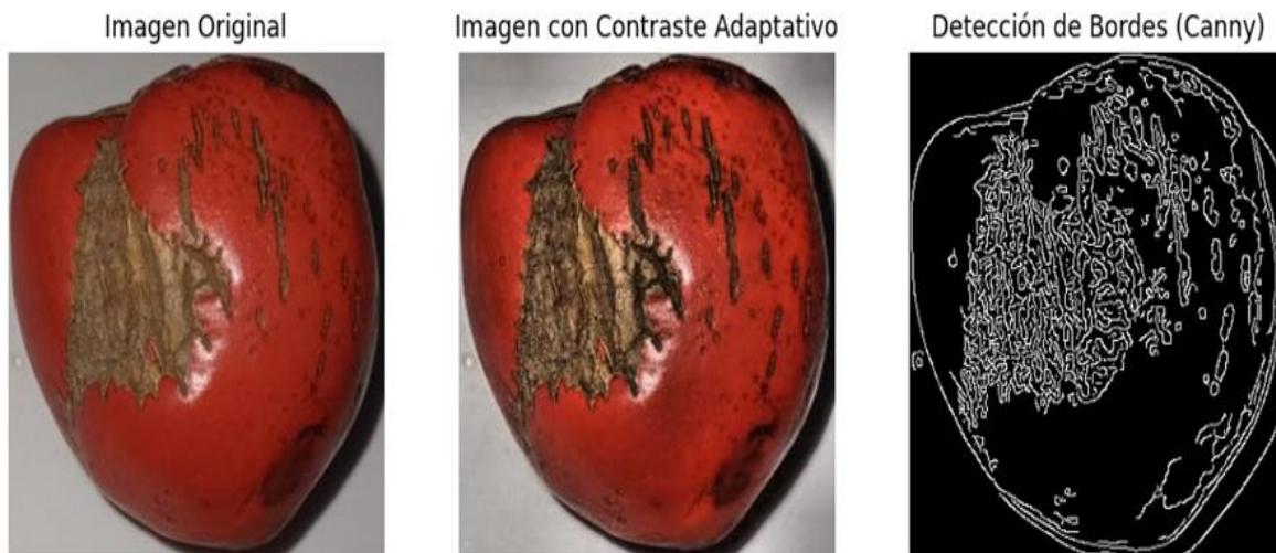
Figura 4-4. Imagen de contraste y detección de bordes
