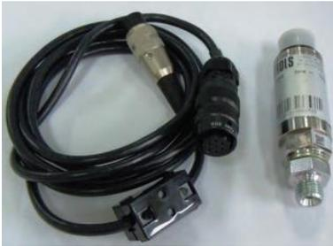
*Nota. Para la automatización del ensayo triaxial se requieren transductores de presión.*
