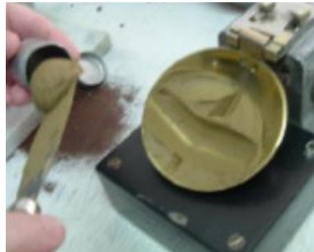
*Nota.* Extracción de la muestra para definición de humedad.
