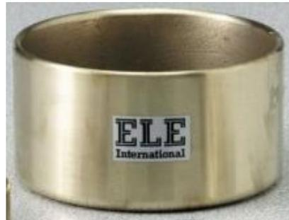
*Nota.* Fabricado en bronce de una sola pieza de 127mm diámetro x 76,2mm de alto.
