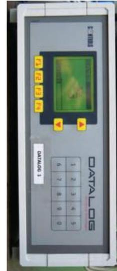
*Nota. Es una nueva serie de los Universal Data Loggers, con 8 canales de micro procesamiento para la adquisición de datos provenientes de las señales eléctricas de los transductores. Fuente: (Salas, 2011)*
