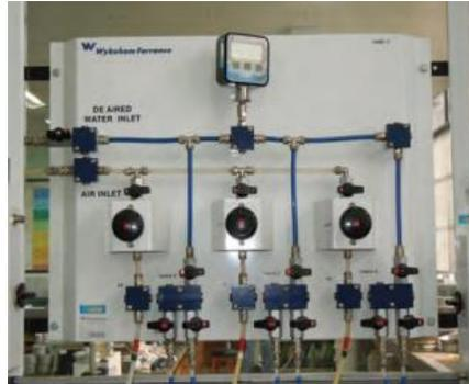
*Nota.* Sistema conformado por válvulas y reguladores mediante los cuales se administra el flujo de aire y agua.
