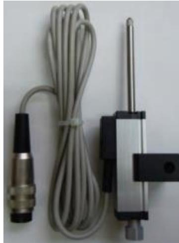
*Nota. Se encargan de transformar una señal eléctrica en una magnitud física, la cual, en este caso, es enviada al datalogger para así poder registrar tanto las presiones a las que está sometido el espécimen como las deformaciones que sufre durante el ensayo. Fuente: (Salas, 2011)*
