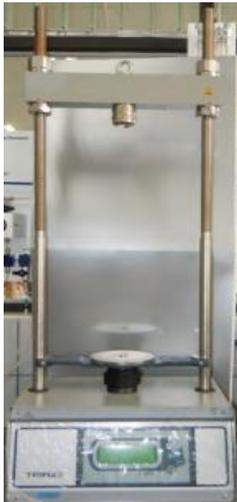
*Nota.* Marco de dos columnas con una viga transversal móvil (marco de carga) y una base que contiene la unidad de empuje mecánico, el motor eléctrico, los componentes electrónicos y los controles. Fuente: (Salas, 2011)
