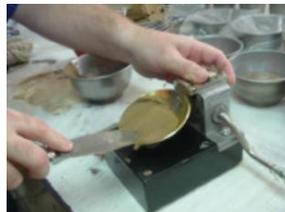
*Nota.* Con un espesor de 1 cm de acuerdo con ASTM D4318; AASHTO T89, T90, INV E-125-13.
