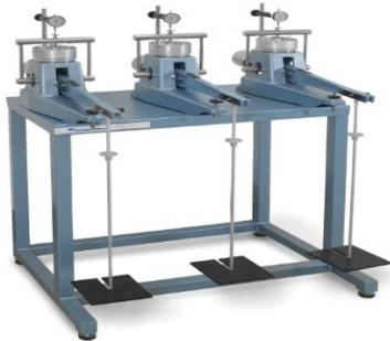
*Nota.* Aparato de carga con una precisión de 0.5% de la carga aplicada
