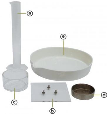
*Nota.* a) Probeta plástica de 25 ml. b) Placa de contracción con púas. c) Recipiente para cristalización Ø 55 mm x 23 mm altura. D) Plato de contracción Monel Ø 45 mm x 12,7 mm altura. e) Cápsula de porcelana de 125 ml.
