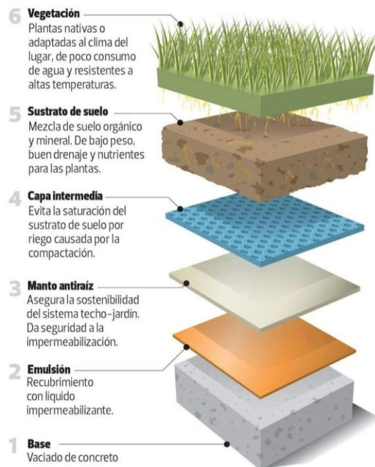
Ilustración 64, Diagrama estructura Cubierta Verde. Fuente: Pinterest
