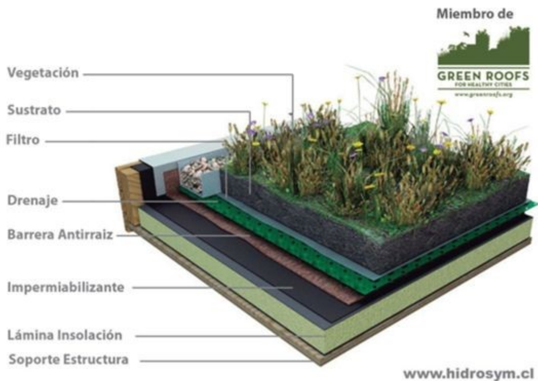
Figura 73, Sistema de cubierta ajardinada, fuente Hidrosym
