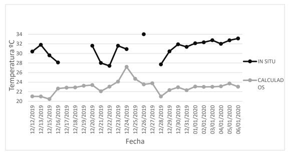
Figura 71: Comparación temperaturas superficiales inferiores por la mañana T3. Fuente: Elaboración propia.
