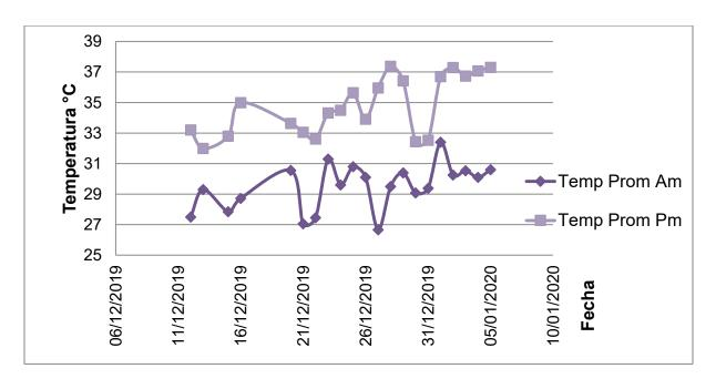
Figura 63: Temperatura en la viga Exterior del puente tizón. Generado en Excel
