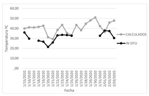
Figura 76: Comparación temperaturas superficies superiores T1 por la tarde. Fuente: Elaboración propia.
