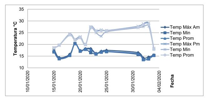
Figura 56Temperatura superficial en la placa inferior durante la mañana y la tarde en el puente Av.
