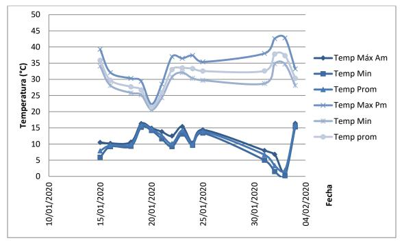
Figura 52: Temperatura superficial en la placa superior durante la mañana y la tarde en el puente Av.
