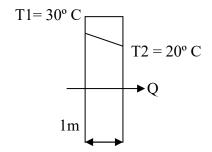
Figura 9: Conducción de calor a través de una pared
