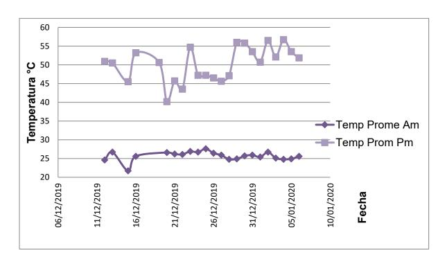
Figura 61: Temperatura en la placa superficial del puente tizón. Generado en Excel
