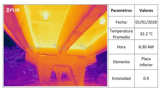
Figura 60: tablero inferior del puente. Formato generado en Excel
