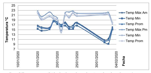
Figura 54Temperatura superficial en la columna durante la mañana y la tarde en el puente Av.
