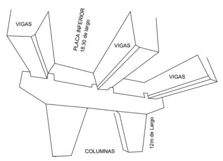
Figura 27 Diseño puente Tizón. Fuente: Elaboración propia
