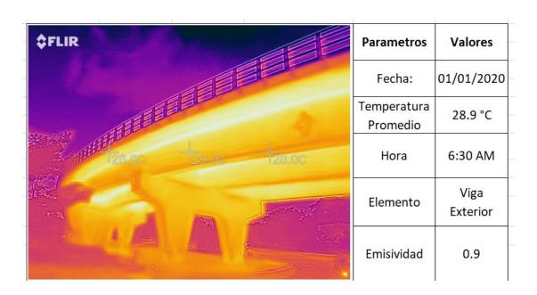
Figura 59: Viga externa del puente. Formato generado en Excel
