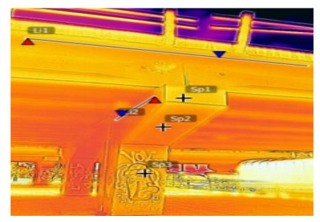
Figura 36: Puntos de interés toma 2 fotografía térmica. Fuente propia.
