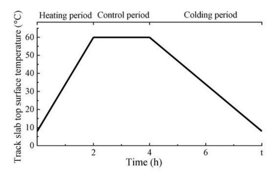
Figura 15Diseño del sistema de carga de temperatura Adaptado de (Lin, J., Briseghella, B., Xue, J.,
