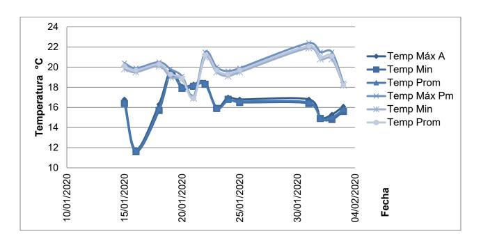
Figura 55Temperatura superficial en la viga durante la mañana y la tarde en el puente Av. Boyacá.
