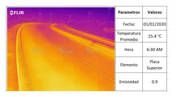
Figura 58: Tablero superior del puente. Formato generado en Excel
