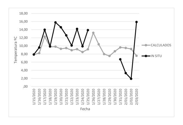
Figura 75: Comparación temperaturas superficies superiores T1 por la mañana. Fuente: Elaboración propia.
