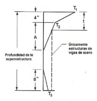
Figura 8: (Gradiente positivo de temperatura vertical en superestructuras de acero y concreto; norma CCP14 sección 3.12.3-1 (CCP-14, 2014) (Bustamante, 2018))
