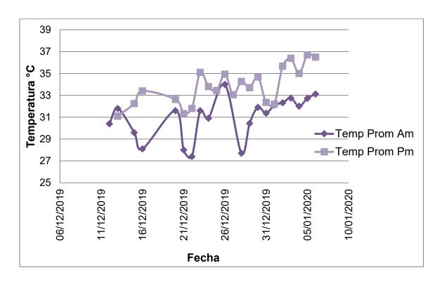
Figura 64: Temperatura en la viga inferior del puente tizón. Generado en Excel
