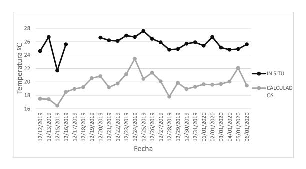
Figura 70: Comparación temperaturas superficiales superiores por la mañana T1. Fuente:
