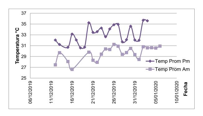
Figura 62: Temperatura en la columna del puente tizón .Generado en Excel
