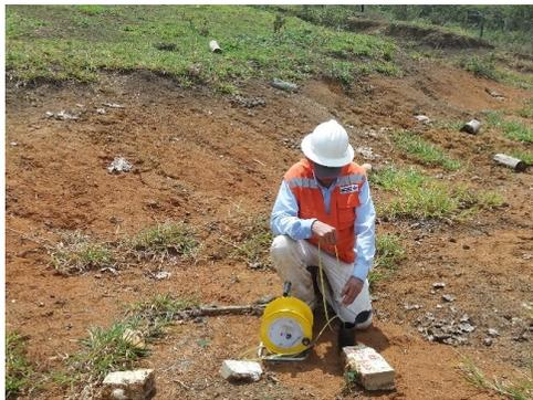
Foto 14. Piezómetro ST5-02B, localizado al noroccidente del casco urbano de Pavas, sobre Suelos Residuales (Qsr).
