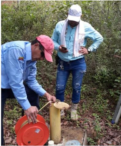
Foto 18. Purga mediante baldeo empleando bailer en el piezómetro PM17\_PZ4.
