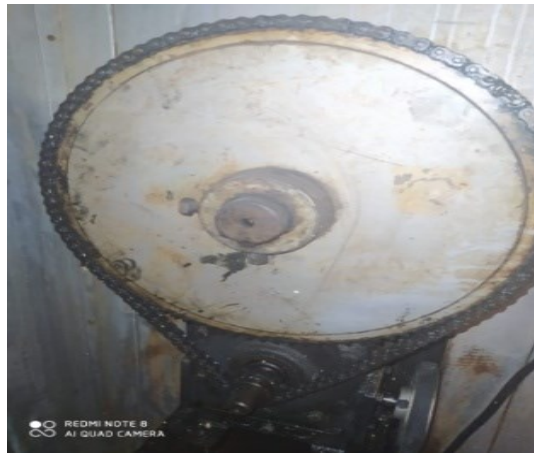
Figura 13. Cadena y plato de transmisión Fuente: Autor
