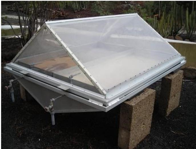
**Figura 1-10** Destilador de dos vertientes. Fuente: Referencia <sup>26</sup>
