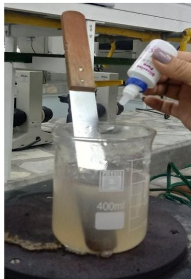
Ilustración 3 obtención de películas, agregado de glicerina líquida Fuente: Elaboración propia
