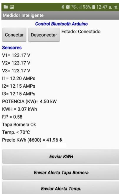
Figura 21. Resultado en aplicación Móvil – Prueba#1. Medidor Inteligente
