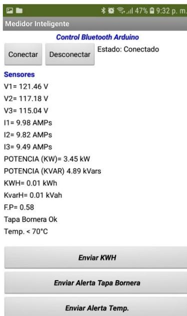
Figura 14. Interfaz aplicación móvil, medidor inteligente.
