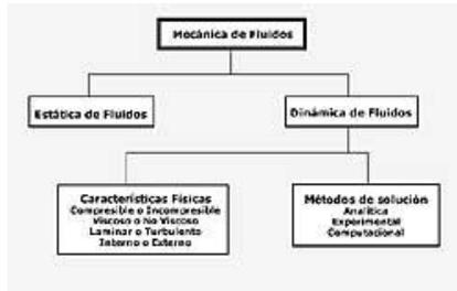
Fig.: 2 Clasificación de mecánica de fluido.
