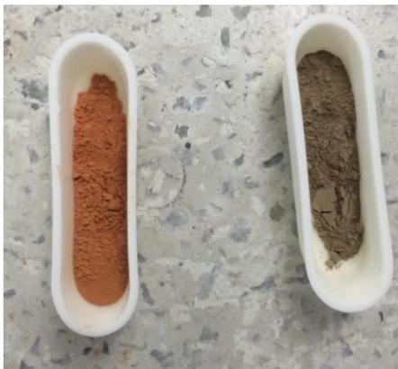
**Figura 4.** Bote de muestra para análisis de CT y CI.
