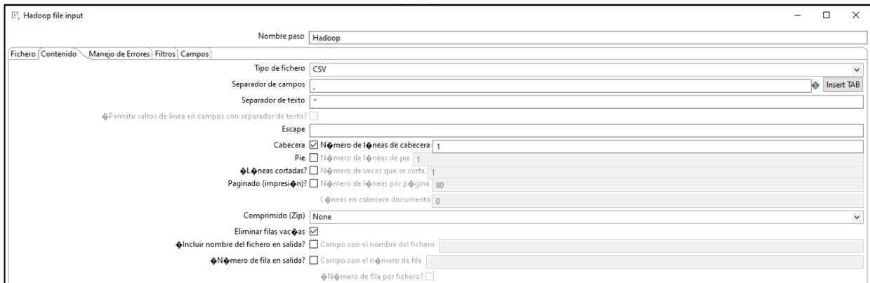
Nota: En la figura se muestra la pestaña contenido en ella se selecciona el tipo de fichero y el delimitador de separación de columnas (,) del archivo o fichero (.CSV)
