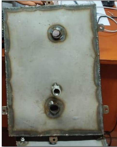
Para finalizar con el prototipo se incluyen dos Niples galvanizado h.g  $\frac{1}{4}$  “, uno de ellos ubicado en la parte lateral superior de la tapa, como se muestra en la figura 22, el segundo está ubicado en la parte lateral inferior del acumulador, como se muestra en la figura 23, con el fin de poder realizar el vacío correspondiente a cada una de sus partes.
