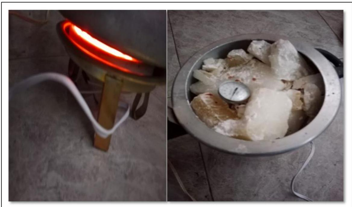
Se procede de la siguiente forma: se toma la muestra de la parafina con un peso de 3000g, se coloca en el recipiente sobre la resistencia de tipo tubular, al tener ya la parafina puesta, se procede a tomar el tiempo correspondiente en el momento en que la parafina se encuentra en su estado de fusión y así poder estimar su temperatura por medio de un termómetro industrial análogo y el tiempo en que sucede este cambio.
