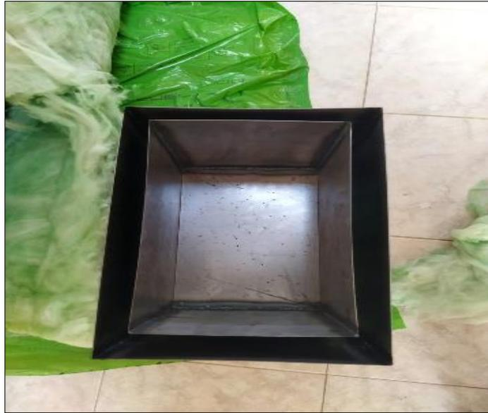
En el cubo interior se rellena con fibra de vidrio con un grosor aproximado de 0,03 m de espesor por cada una de sus paredes, utilizado como aislante térmico. a continuación, se ilustra en la figura 17.
