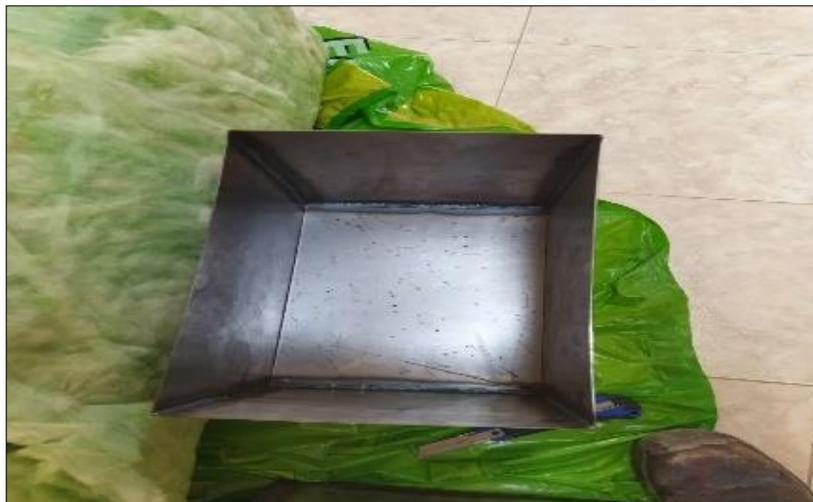
Para la segunda parte se procede a cortar una lámina de “0,89 m x 0,45 m”, realizando dos dobleces en 0,30 para poder construir el otro cubo cortado dos laminas con
