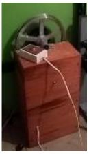
Nota: la mesa está recubierta por 3 láminas de triplex y en una de sus caras tiene el interruptor para el sentido de giro del motor. (Autoría propia)
