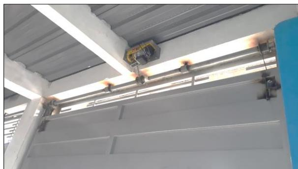
Figura 17. Diferencial eléctrico, tubo principal, sistema de rodaje y guayas. Fuente: propia
