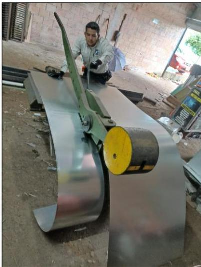
Fig. 13: corte de lámina para fabricación de secciones de portón. Fuente: propia
