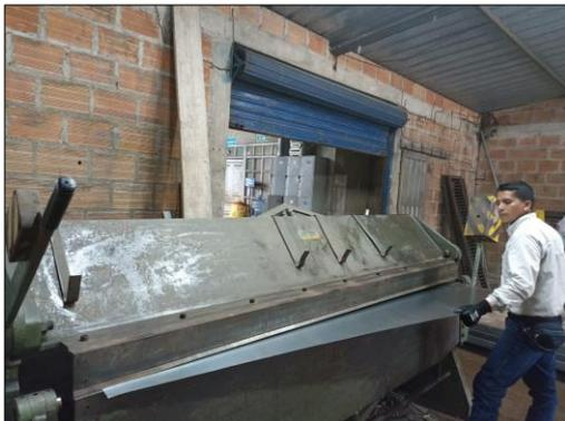
Fig. 14: doble de lámina para secciones de portón. Fuente: propia
