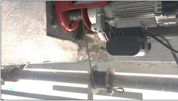
Figura 18. Conexión entre el tubo principal y el diferencial conectados a través de una guaya. Fuente: propia
