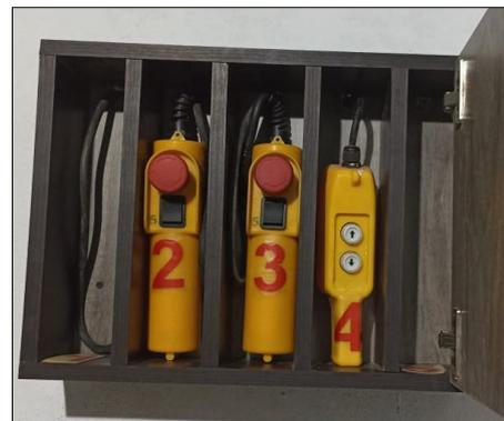
Figura 20. Caja para controles de accionamiento. Fuente: propia
