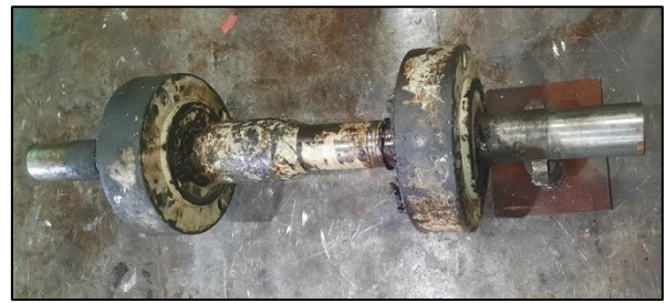
Fig. 1. Eje de ventilador retirado de aerofriador junto con rodamientos. Fuente: Los autores.
