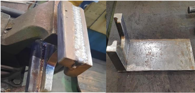
Fig. 20. Armado y aplicación de soldadura 7018. Fuente: Los autores.
