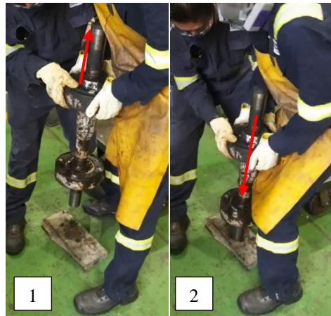
Fig. 2. Procedimiento realizado actualmente para el retiro del manguito fijador. 1) Se levanta eje y 2) Se golpea contra placa metálica hasta separar el cojinete del manguito. Fuente: Los autores.
