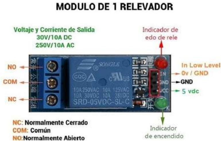
Figura 2-13 Esquema módulo relé
