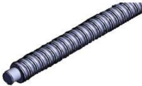
Figura 4-2 Tornillo de Avance hecho en SolidWorks
