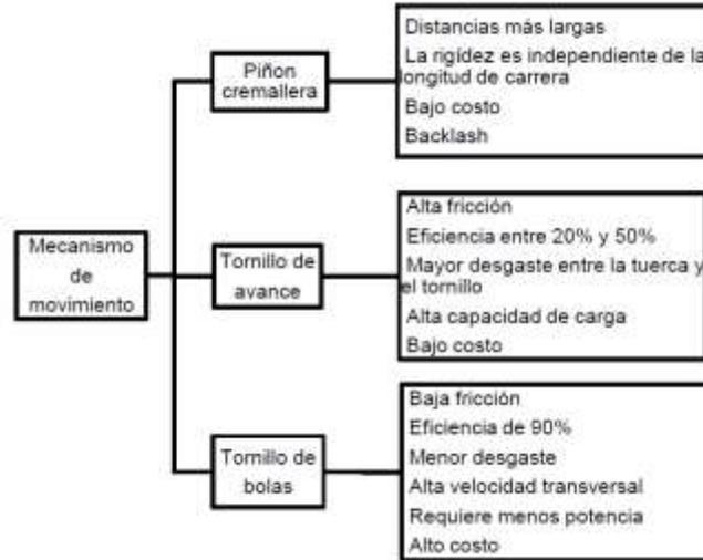
Figura 3-3 Diagrama de mecanismos de movimiento [28]
