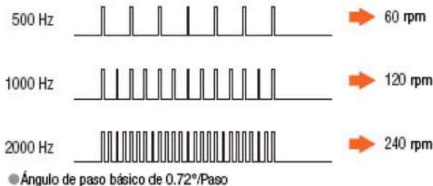
Figura 2-11 Relación frecuencia velocidad de un motor a pasos [32]
