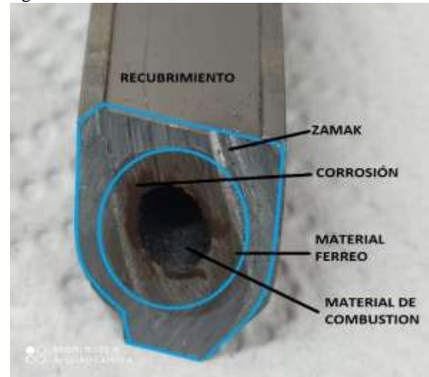
Fig.6. sobre el zamak en el cañón de un arma traumática
