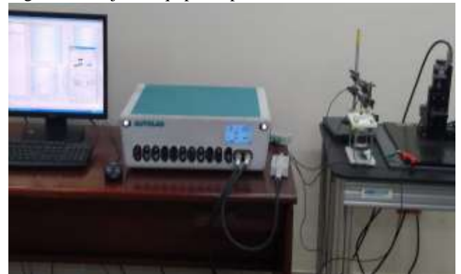
Fig. 11 montaje en equipo de prueba de corrosión
