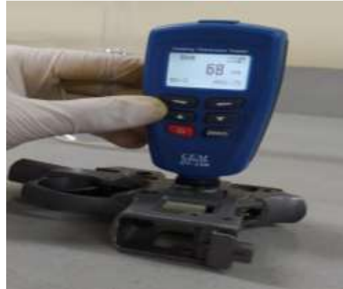
Fig.9, uso del espesimetro, indicando un espesor de 68 µm
