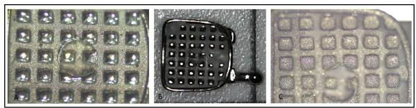
(A) bracket nuevo, (B) mismo bracket descementado, (C) Bracket reacondicionado con técnica de microarenado.
