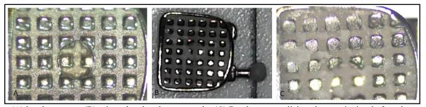
(A) bracket nuevo, (B) mismo bracket descementado, (C) Bracket reacondicionado con técnica de fresado.
