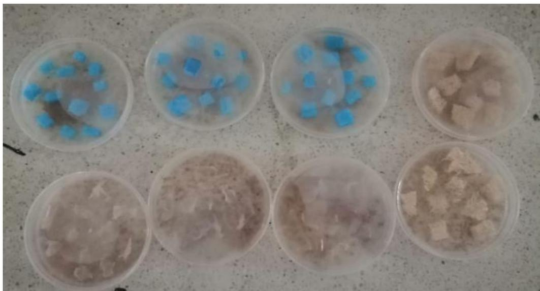
*Ilustración 9 medios de cultivo alternativo con los materiales para realizar los experimentos de inmovilización con lignina soluble Fuente: autor*
