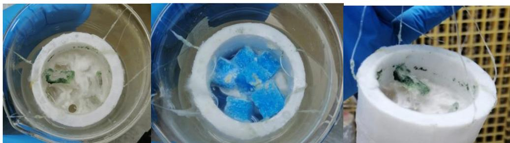
Ilustración 11 cartuchos para la inmovilización con el material y el hongo al finalizar el experimento
