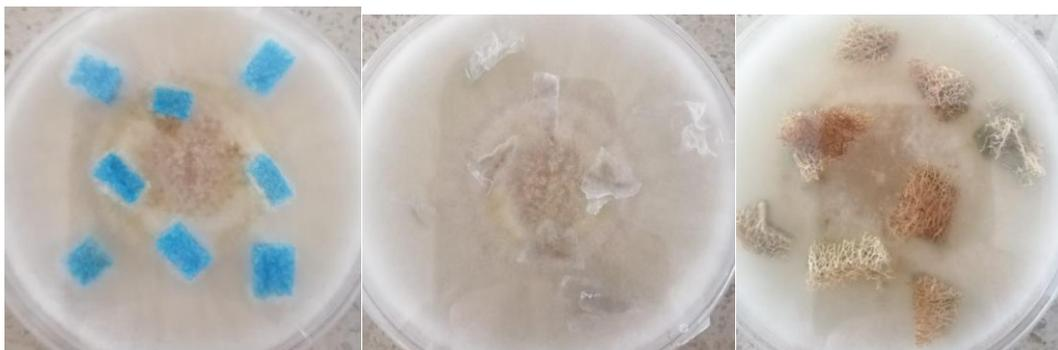
*Ilustración 7 en el lado izquierdo caja de Petri con PDA, inoculada con Trichoderma sp y espuma, en el centro caja de Petri con PDA, inoculada con Trichoderma sp y PET, en el lado derecho caja de Petri con PDA, inoculada con Trichoderma sp y estropajo. Después de una semana de contacto con el material.*
