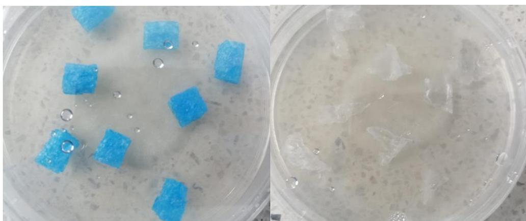
*Ilustración 6 en el lado izquierdo caja de Petri con PDA, inoculada con Trichoderma sp y espuma, al lado derecho caja de Petri con PDA, inoculada con Trichoderma sp y PET. Día uno de contacto con el material.*
