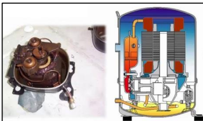
Figura 2. Lubricación por salpicadura
