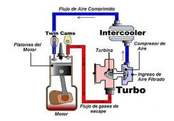
Fig. 5. Sistema de admisión y de escape imagen tomada de la página web: <a href="https://maqpe.com/sistema-escape/sistema-de-admision-y-escape-de-motores-diesel/">https://maqpe.com/sistema-escape/sistema-de-admision-y-escape-de-motores-diesel/</a>
