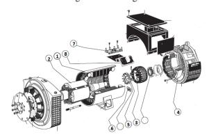
Fig. 6. Partes de un generador. Imagen tomada de manual de un generador Leroy LL 1000 de 2 y 4 polos.
