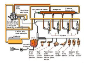
Fig. 4. Sistema de inyección común riel tomada página web: https://mecatronnix.blogspot.com/2019/08/mecatronnix-motores-diesel-sistema.html
