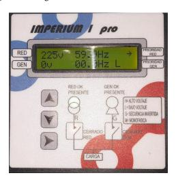
Fig. 12. PLC IMPERIUM 1 PRO. Foto tomada de una transferencia automática.
