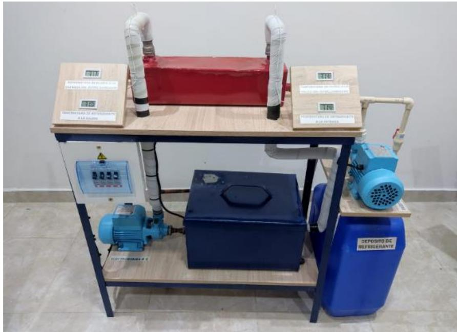
Figura 1. Sistema de transferencia e Intercambiador de placas
