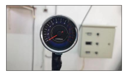
Figura 2 – Tacómetro analógico
