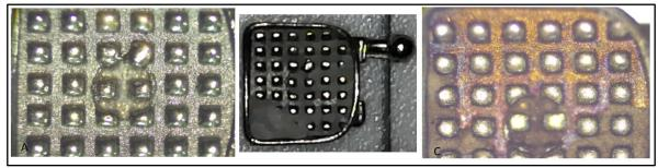
(A) bracket nuevo, (B) mismo bracket descementado, (C) Bracket reacondicionado con técnica de flameado.
