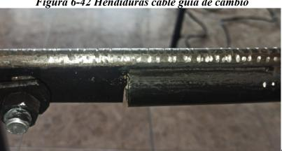
Figura 6-42 Hendiduras cable guía de cambio
