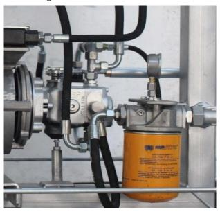
Figura 4-18. Bomba hidráulica.
