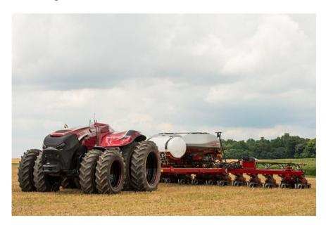
Figura 4-21. Tractor automatizado CNH industrial.
