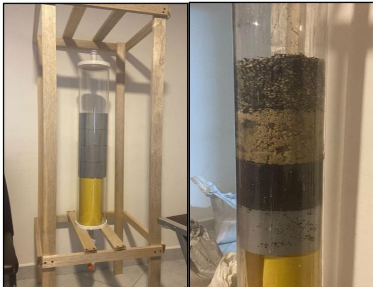
Figura 14 - Construcción de Filtro
